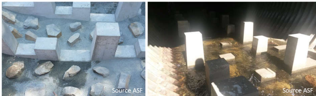
Planche photographique 3 : Macro-rugosités implantées dans la buse.
