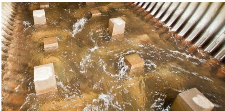
Planche photographique 4 : Hétérogénéité des écoulements générée par les macro-rugosités.
