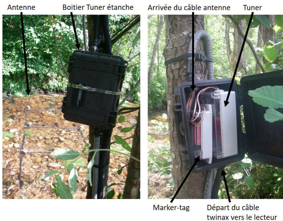
Planche photographique 9 : Illustration de la partie boîtier tuner du dispositif.
