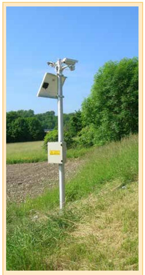
Ci-dessus : Mât avec à sa tête capteur infrarouge et caméra pouvant détecter des animaux.
