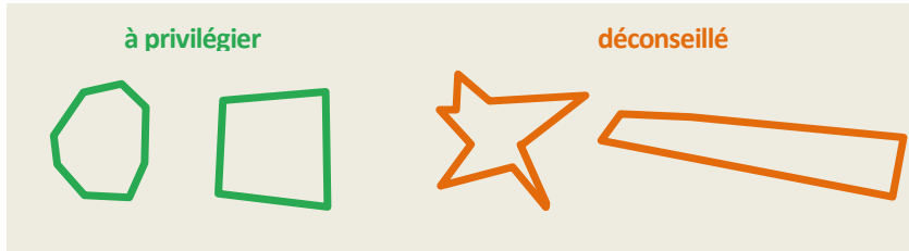
ill. 82. Plans de masse des exclos suggérés ou déconseillés, visant à limiter les effets sur la faune. Ces principes généraux sont donnés à surface constante et à titre indicatif. Ils sont à adapter par une expertise faunistique locale. P. ex., on évitera de barrer un corridor écologique identifié.
