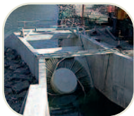
VLH (Very Low Head) Tests en cours 1,5 à 3 m de chute Q = 10 à 30 m 3 /s
