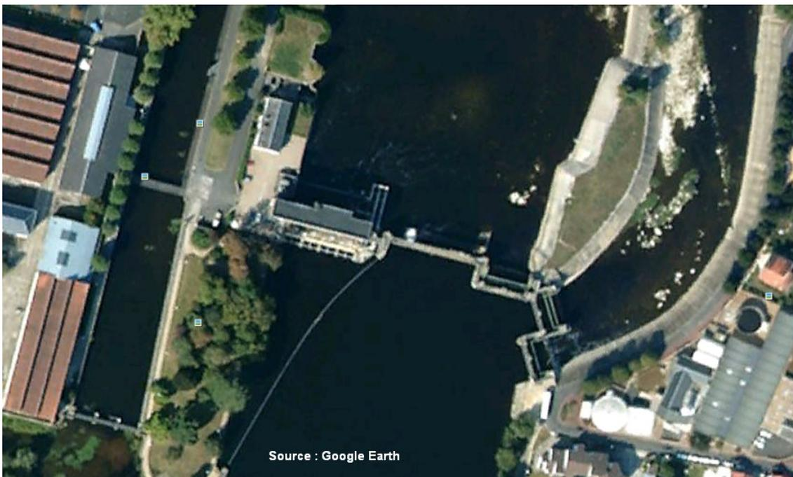
**Figure 14 : vue aérienne du barrage de Châtellerault (86). Il est difficile de se rendre compte à partir de la photo que cet ouvrage fait un peu moins de 6 m de haut.**
