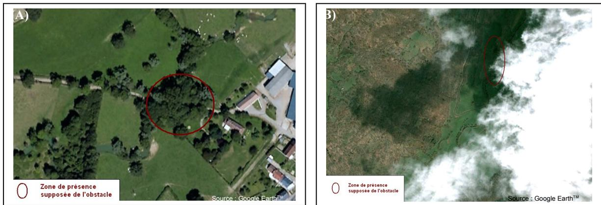
**Figure 15 : exemple de deux cas où la localisation des ouvrages n'est pas possible avec les photos aériennes, ceux-ci étant masqué par des arbres (A) ou un nuage (B)**
