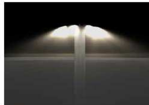
APRES : Projecteurs asymétriques sur mât de grande hauteur après rénovation - puissance installée : 6 kW (-50%) - taux ULOR 0%.
