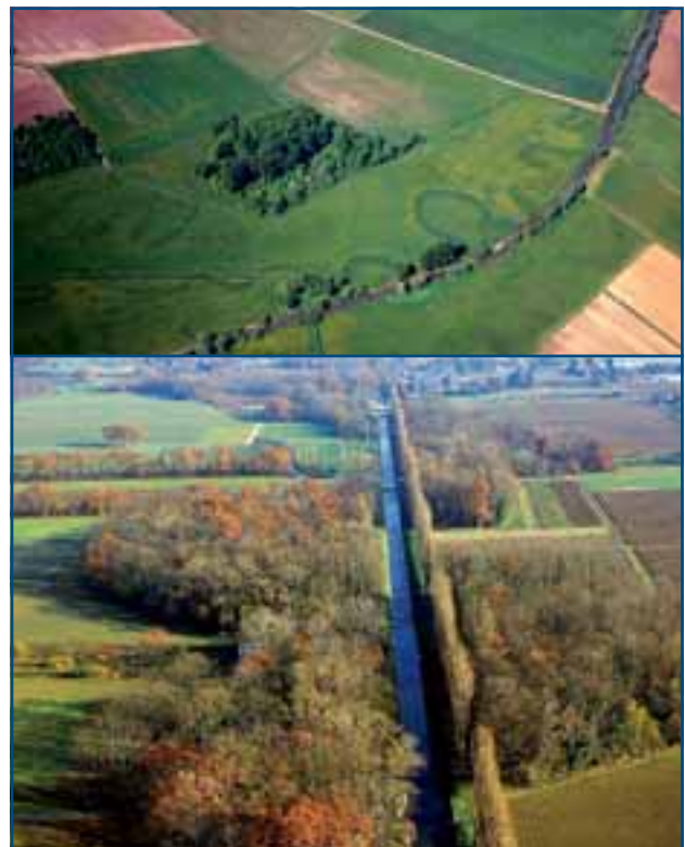
↑ Figure 21 : Exemples de rescindements de méandres à vocation principalement agricole : en haut l'Orain (39), en bas l'Aire (Suisse). 🌊
