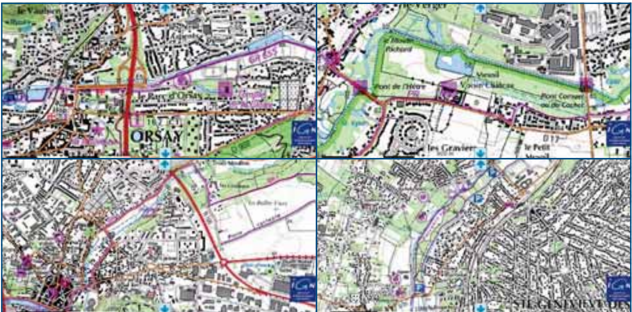
↑ Figure 40 : Quatre exemples de cours d'eau en traversée urbaine ou périurbaine. Le tracé est généralement rectiligne et les berges longées par des routes ou des chemins, donc protégées contre l'érosion (source : Géoportail, IGN). 🌊
